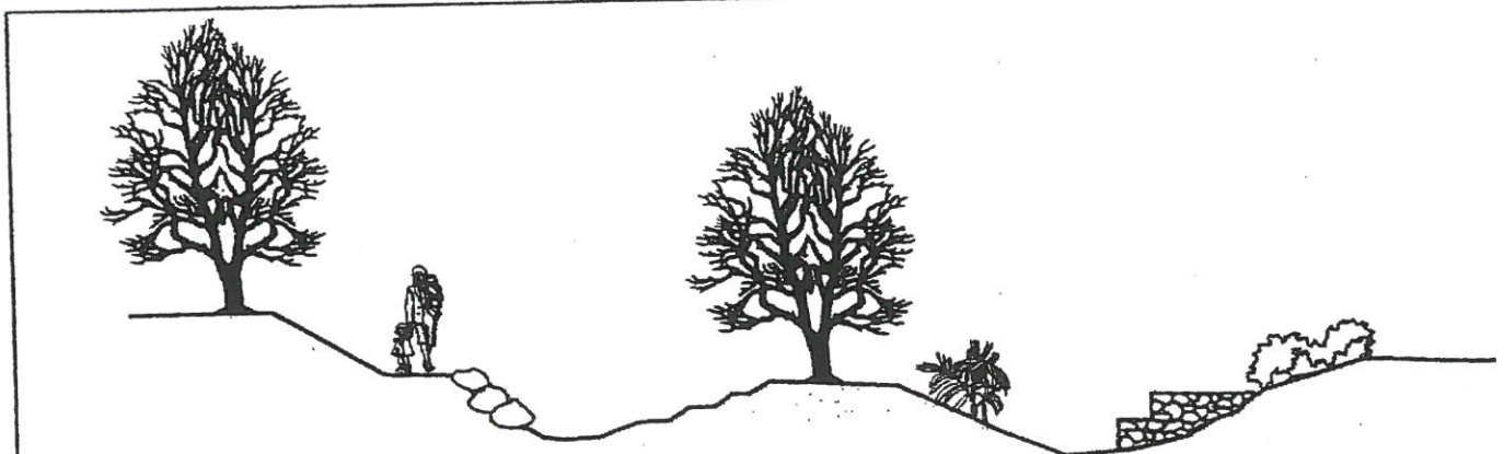
Exemple de noue réalisée dans un espace vert Noues paysagères de Valence-Lautagne ( Sources Riou V, Jean F )
